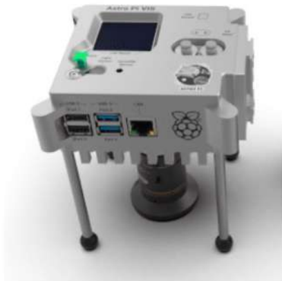
Raspberry Pi, Astro Pi e fotocamera a bordo
